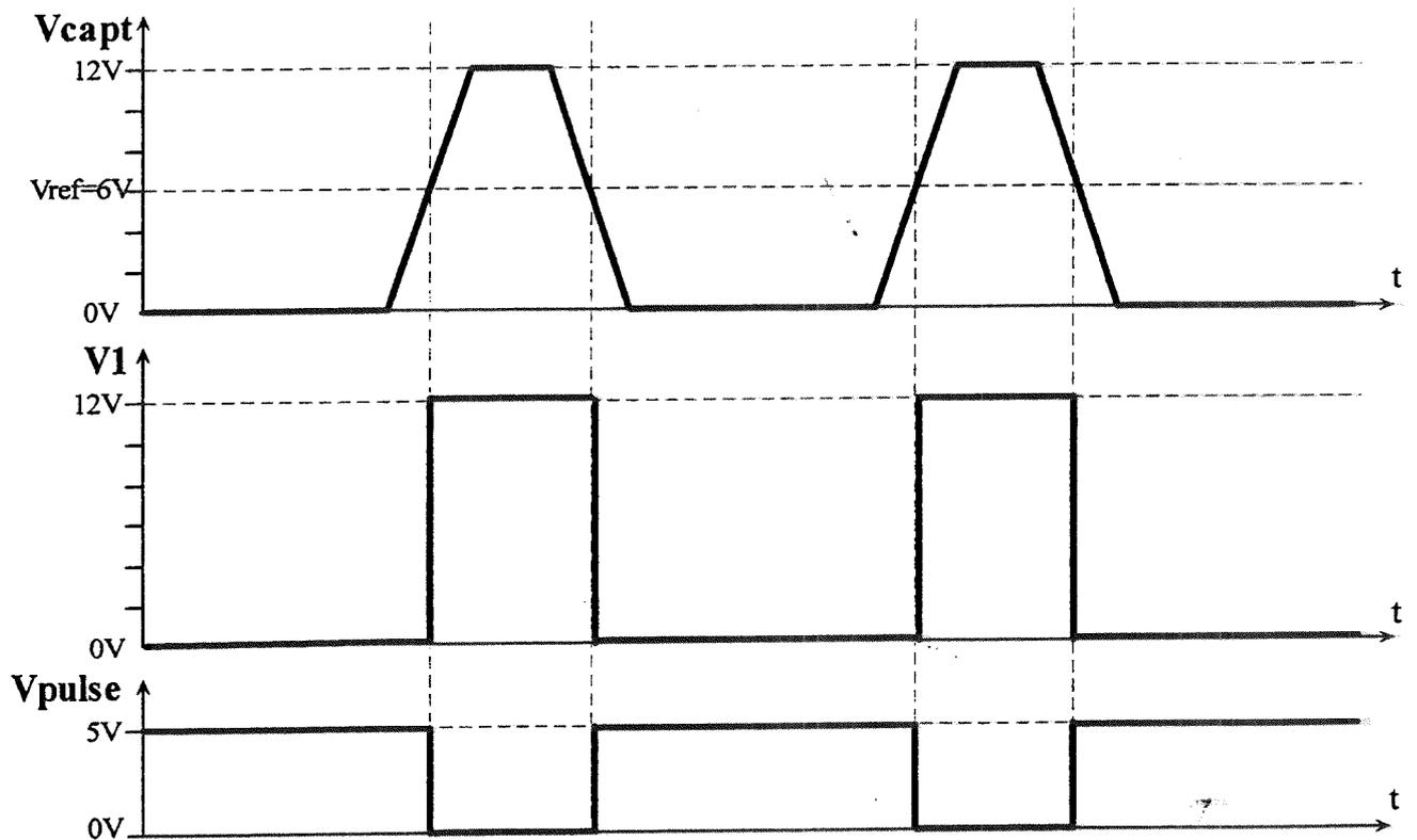
Le capteur à effet HALL génère des impulsions  $V_{capt}$  d'amplitude 12V, pouvant être parasitées.
