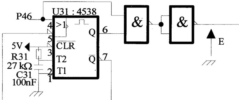
22) A l'aide de la documentation de U31 (4538) (**pages AE 4/9**), déterminer la durée de l'impulsion sur la sortie Q du monostable lors du déclenchement de celui-ci.
